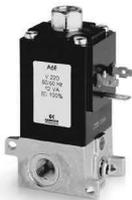
Electroválvulas manifold equipadas de mando manual. Disponibles con conexiones de G1/8 a la entrada y con utilizaciones de G1/8 o bien con cartucho Ø 4. El cuerpo se suministra con OR y tornillos.
