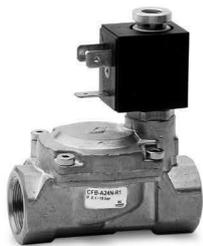
El piloto de estas válvulas controla la posición del diafragma a través de una presión diferencial. Estas válvulas son excelentes para el control de los altos rangos de flujo de fluidos y para muy bajas presiones de trabajo.
