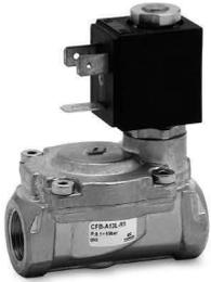
El piloto de estas válvulas controla la posición del diafragma a través de una presión diferencial. Estas válvulas son excelentes para el control de los altos rangos de flujo de fluidos y para presiones muy bajas de trabajo.
