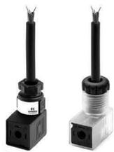
El rectificador del circuito interno de este conector permite usar válvulas con corriente alterna en diferentes voltajes, aun si el voltaje indicado sobre la válvula es corriente continua.
