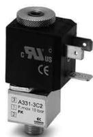
La electroválvula de 3/2 vías NC (cerrada) ha sido realizada para el accionamiento de pequeños cilindros de simple efecto y para el pilotaje de válvulas neumáticas con presiones de trabajo mínimas.
